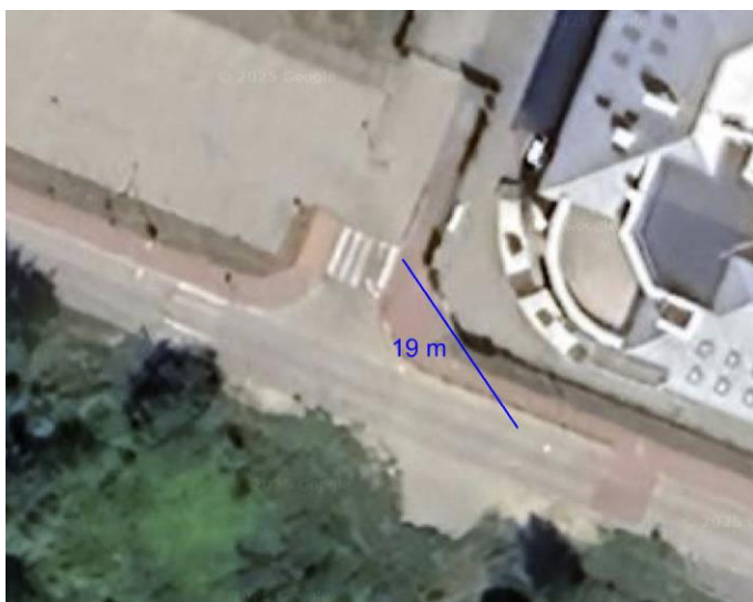
Rys. 9: Analiza widoczności pieszego przed przejściem – widok z góry z pomiarami. Źródło: Google Maps, dodane oznaczenia własne.
