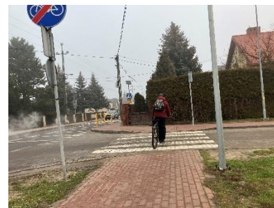
Zdjęcie 28, 29, 30: Nieprawidłowe zastosowanie znaku D-6b przy braku wyznaczonego przejazdu dla rowerów. Na zdjęciu 30 widoczny ruch rowerowy przez przejście dla pieszych, co wskazuje na potrzebę dostosowania infrastruktury. Źródło: własne.
