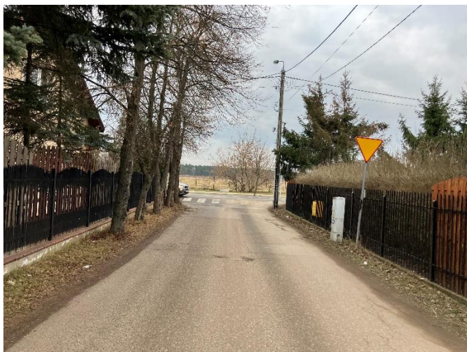
Zdjęcie 44: Znak A-7 na skrzyżowaniu ul. Podgórnej z ul. Kościelną – brak wymaganej widoczności. Źródło: własne.
